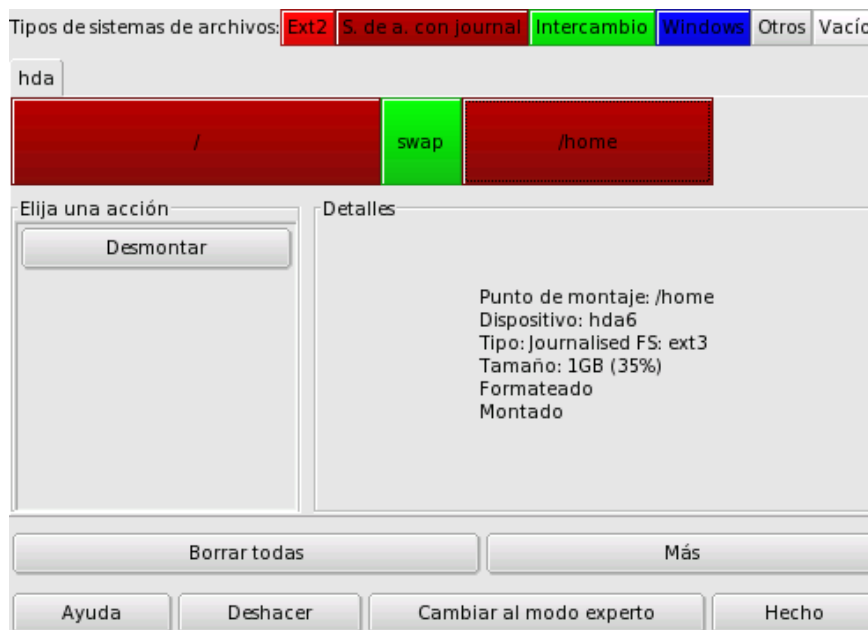
Figura 17-2. La partición /home antes de cambiarle el tamaño
